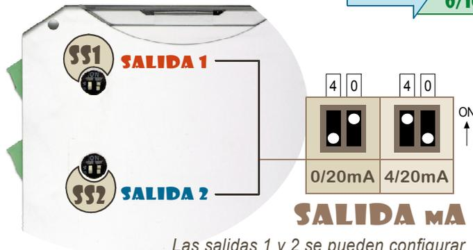
Las salidas 1 y 2 se pueden configurar individualmente mediante los microswitches SS1 y SS2 como salidas 0/20mA ó 4/20mA.
